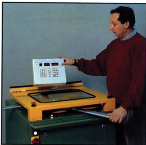
Schlappi maakt gebruik van moderne programmeerbare buigmachines voor het op maat buigen van aluminium markiesprofielen.
